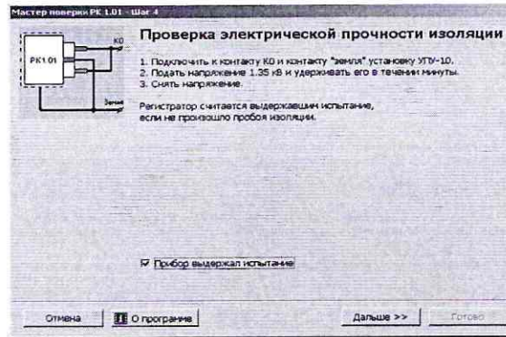
Рисунок А.3.5 - Вид окна «Проверка электрической прочности изоляции» программы «Мастер поверки РК1.01»
